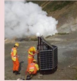
GNSS火山変動リモート観測装置
