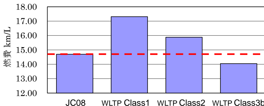
図2 Class2 が適用される車両(最高速度 120km/h 以上)における各サイクル(超高速フェーズは除外)での燃費試験の結果
