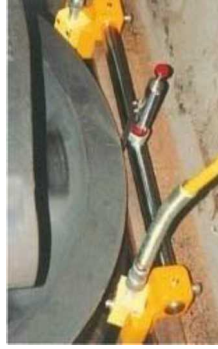
写真）輪重測定器
