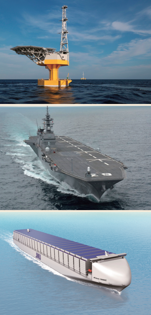
上/JMUが建造した、福島復興・浮体式洋上風力発電の変電所「ふくしま 絆」(写真提供:福島洋上風力コンソーシアム) 中/今年3月に防衛省に引き渡した、海上自衛隊最大の護衛艦「いずも」です。約250mの飛行甲板があり、我が国の有事に加え、災害派遣および国際緊急援助活動において陸上自衛隊などの輸送および医療活動などの多様な任務にも期待されています。 下/環境負荷低減コンテナ船(開発モデル)
