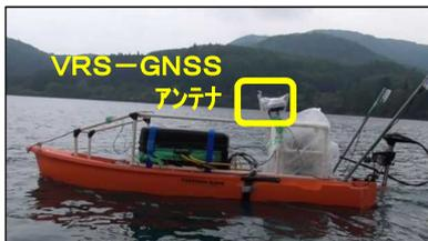
ASV (Autonomous Surface Vehicle):自動航行式ボート
