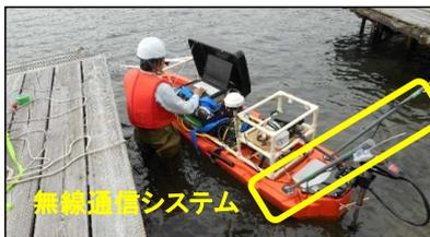
音響測深機およびASVの起動
