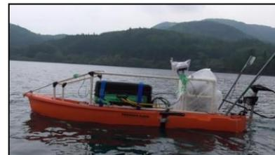
ASV(Autonomous Surface Vehicle);自律航行式ボート
