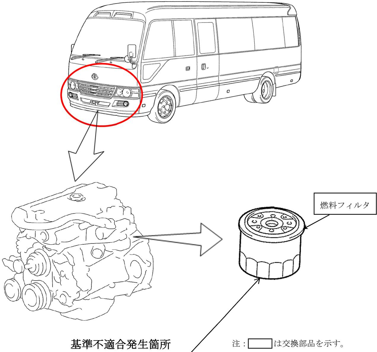
ディーゼル車の燃料装置において、原動機に取り付けられている燃料フィルタの強度が不足しているため、頻繁に原動機の始動、停止を行うと燃料圧力の変動により、燃料フィルタのケースに亀裂が入るものがある。そのため、そのままの状態で使用を続けると、亀裂が進行しフィルタケースが破損して、最悪の場合、燃料が漏れるおそれがある。
