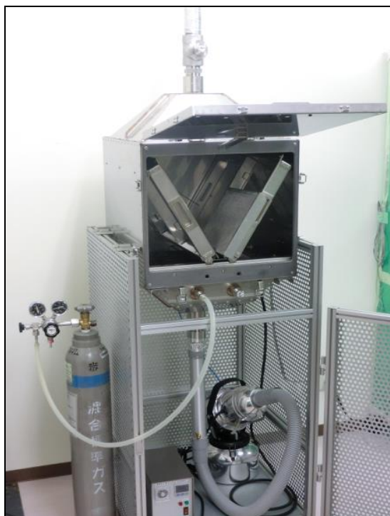
写真-3 加熱再生装置（実機）
