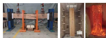
構造試験状況 耐火試験状況
