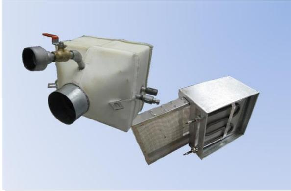
加熱再生装置（試作1号機）
