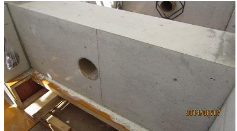
【有開孔梁 試験体製作状況】
