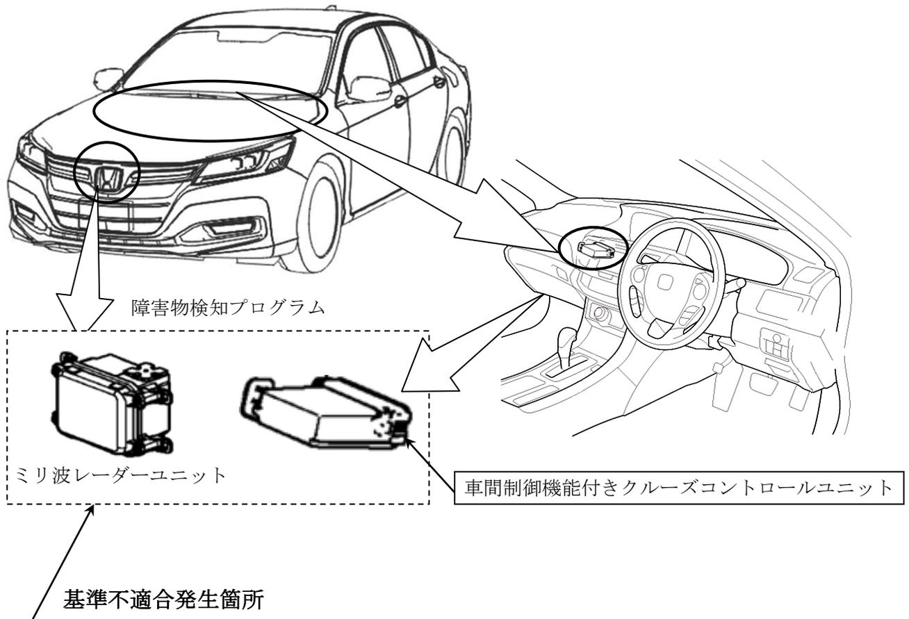
前方障害物衝突軽減装置（衝突軽減ブレーキシステム）において、車間制御機能付クルーズコントロールユニット補修用部品の管理が不適切なため、旧部品が組み付けられたものがある。そのため、路肩や中央分離帯等に防護柵があり、先行車との車間距離が離れた際に、受信したミリ波情報を稀に前方障害物と誤認識し、衝突の可能性がないのに、マルチインフォメーションディスプレイに警告表示がされるとともに警告音を発し、予期せぬ急制動がかかるおそれがある。
