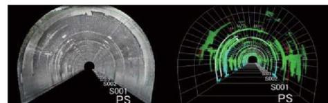
連続画像の貼り合わせ状況(左)と損傷マップ(右)覆工表面の変状を客観的に評価でき、進行性の把握に寄与できる。
