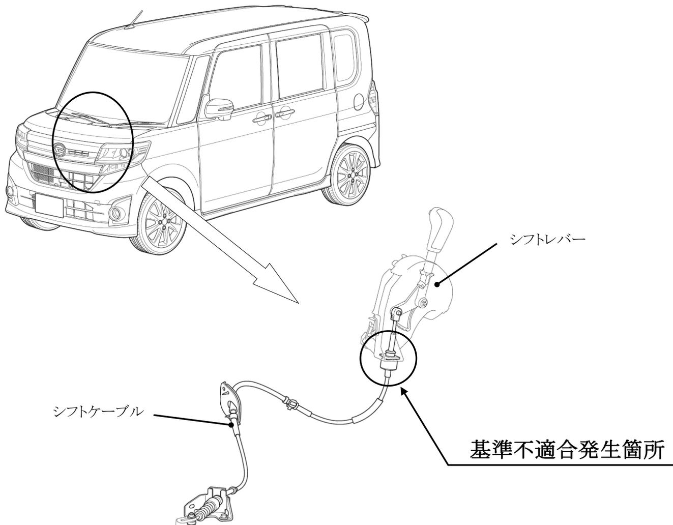
自動変速機において、シフトケーブル固定部の組付けが不適切なため、当該固定部の嵌合が不十分なものがある。そのため、そのままの状態で使用を続けると、シフトケーブルが固定部から外れてシフトレバーの位置と異なるレンジに固定され、最悪の場合、意図せず車両が動き出すおそれがある。
