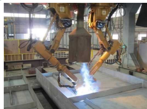
溶接ロボット (90年代から導入)
