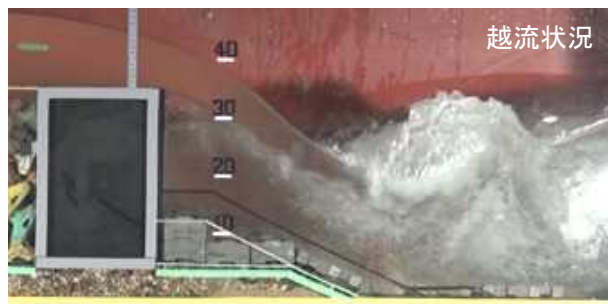
図 V-2.23 津波越流の水理模型実験
