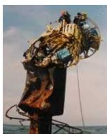
損傷した浮体式灯標
