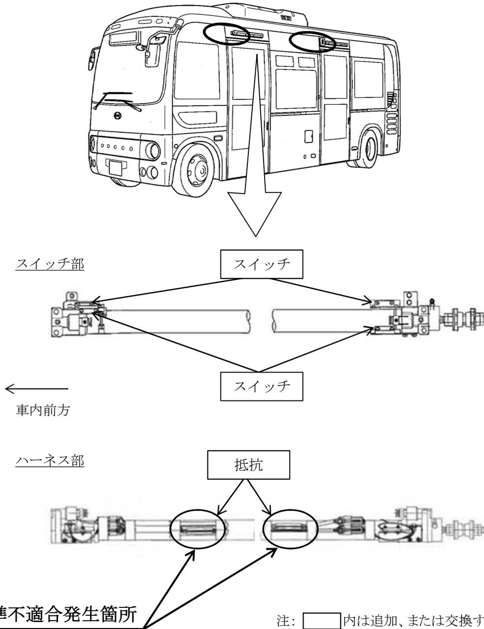
小型ノンステップバスの扉において、扉の位置を検知するスイッチの回路が不適切なため、当該スイッチがオンになった際、接点に定格値を超える電流が流れ、接点が荒れるものがある。そのため、そのまま使用を続けると、接点どうしが導通したままとなり、最悪の場合、扉が閉められなくなるおそれがある。
