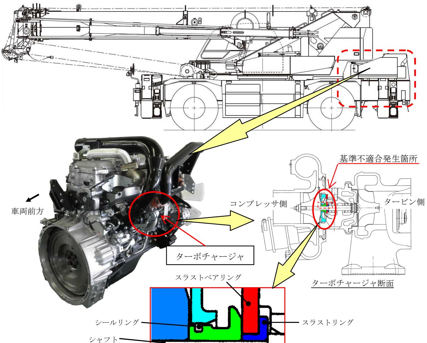
ホイールクレーンの原動機において、エンジンオイルの潤滑性が低下した状況下におけるターボチャージャのスラストベアリングの耐久性が不足しているため、当該状況下で繰り返しエンジンに高負荷を加えたり高回転域で使用すると、スラストベアリングおよびスラストリングに摩耗を生じることがある。そのため、ターボチャージャのシャフトにガタつきが生じ、そのままの状態で使用を続けると、ターボチャージャのシールリングが損傷してエンジンオイルが漏れ出し、当該オイルがエンジン内部、排気系に入り込み、白煙、異音、エンジン回転数の上昇等の不具合が発生し、最悪の場合、エンジンが破損するおそれがある。
