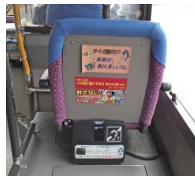
バスに設置されている磁気ループ
