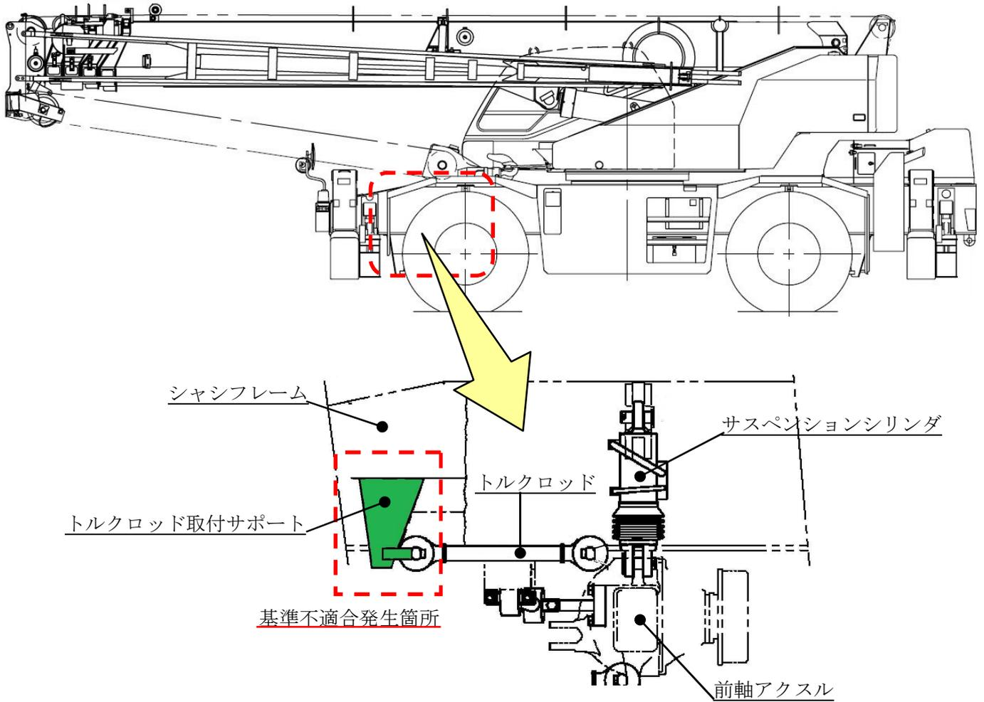
ホイール・クレーンの緩衝装置において、トルクロッド取付サポートの強度が不足しているため、急制動をかけたとき、当該サポートの取付部に疲労限度を超える応力がかかることがある。そのため、トルクロッド取付サポートの取付部に亀裂が入り、そのままの状態で使用を続けると、トルクロッド取付サポートの取付部が破損して、トルクロッドが外れるおそれがある。
