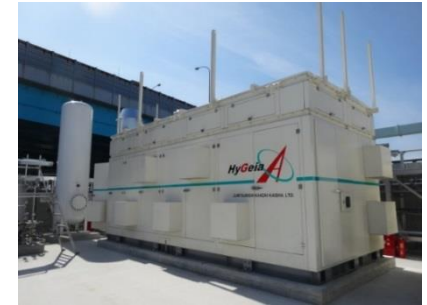
水素製造装置
