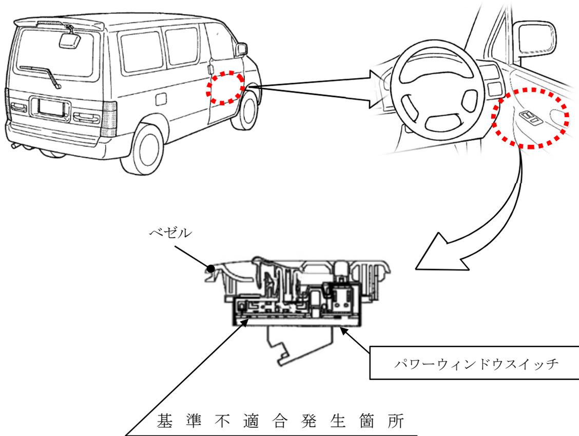
運転席ドア部のパワーウィンドウスイッチにおいて、内部構造が不適切なため、多量の水分がスイッチ内部に侵入すると、スイッチ内部の基板に異常電流が流れることがある。そのため、当該部位が発熱、溶損し、最悪の場合、発火するおそれがある。
