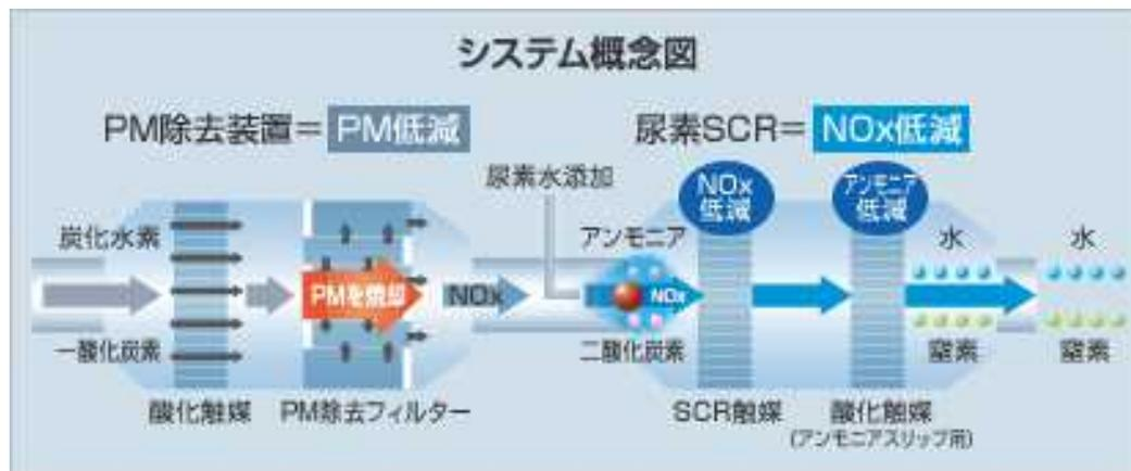
尿素水をSCR触媒前方の排気管内に噴射し、SCR触媒においてアンモニア( $\text{NH}_3$ )によりNOxを窒素( $\text{N}_2$ )に還元する技術。
