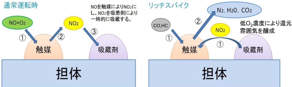
通常運転時はNOxを触媒上に吸蔵させ、時折、リッチスパイク(燃料を多めに噴射すること)により、排出ガス中の酸素(O<sub>2</sub>)を低減かつ、一酸化炭素(CO)、炭化水素(HC)等を増加させ、吸蔵したNOxと反応させてN<sub>2</sub>に還元する技術。
