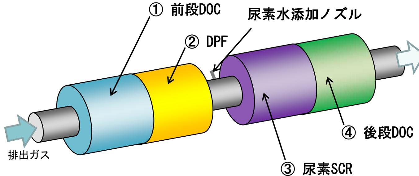
車両に搭載した尿素水の加水分解により生じる $\text{NH}_3$ を還元剤として、排出ガス中の $\text{NO}_x$ を $\text{N}_2$ と水( $\text{H}_2\text{O}$ )に還元するSCRを中心とする触媒システム。
