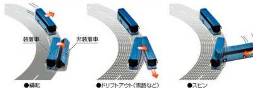
〈車両安定制御システム 装着車と非装着車の比較〉
