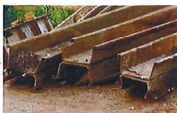
コの字形のシートパイルを背合わせに溶接して「H形鋼」に。以前、鉄建のエンジニアリング本部に所属していた本島工事主任が強度を検証済み
