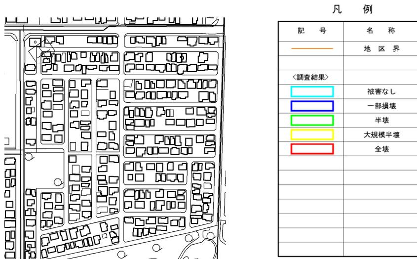
図-14 住宅被害認定による建物の被害程度マップ
