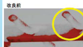
改良前はアンテナ素子上に着雪が見られる
