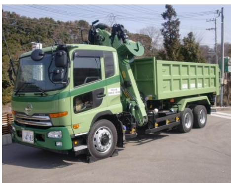
木材運搬用のグラップルクレーン付きトラック
