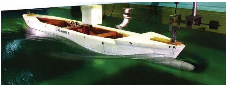
図 24. 波形写真 (ペアレント FULL トリム 1%) 船速 12.5knots
