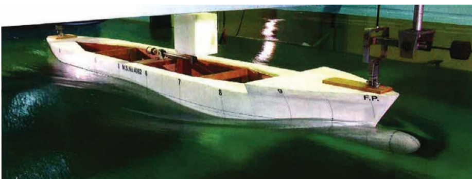
図 26. 波形写真 (ペアレント FULL trim2%) 船速 12.5knots
