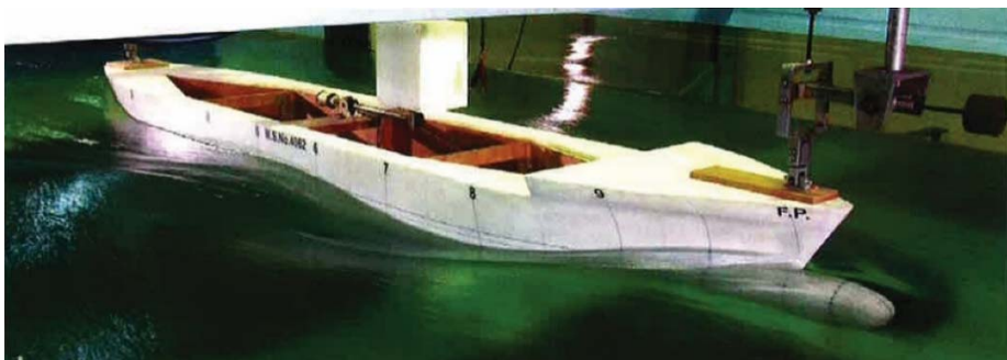
図 25. 波形写真 (ペアレント FULL トリム 1.5%) 船速 12.5knots
