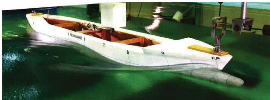
図 23. 波形写真 (ペアレント FULL トリム 0%) 船速 12.5knots
