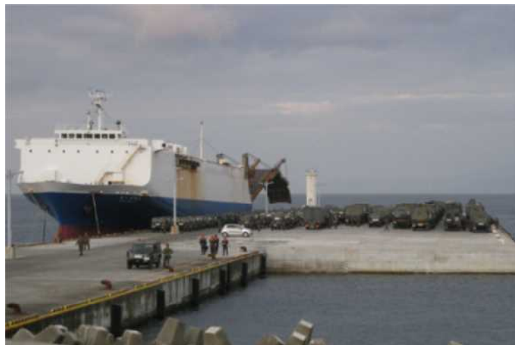
図－５ RORO船のランプウェイ配置例（ひまわり7）
