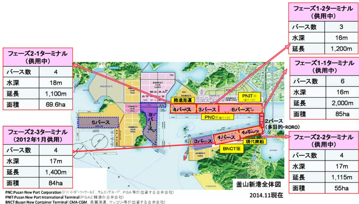
図 2.24 釜山港（釜山新港コンテナターミナル）の概要
