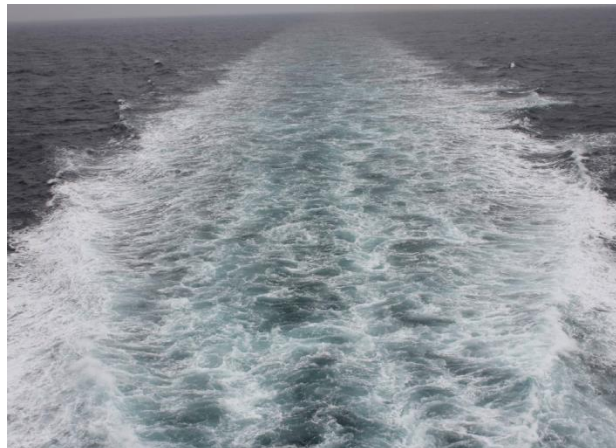
空気潤滑“OFF”状態での航跡
