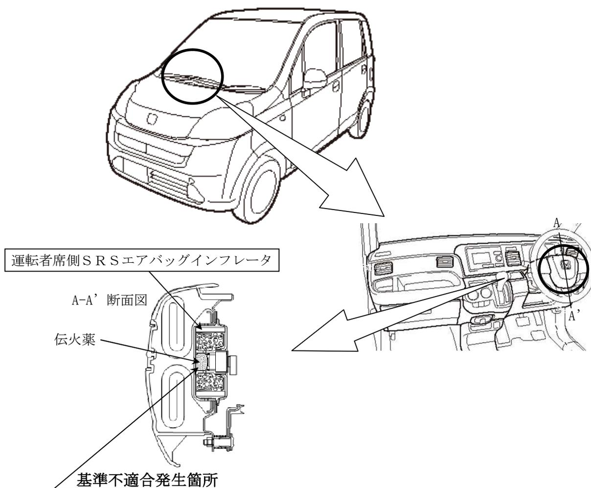
運転者席側SRSエアバッグインフレーター（膨張装置）において、ガス発生剤を燃焼させる伝火薬が不適切なため、衝突時にガス発生剤が燃焼しないものがある。そのため、エアバッグが正常に展開しないおそれがある。
