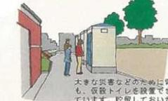
大きな災害などのために電気や水道がストップしても、仮設トイレを設置できるような配管構造になっています。貯留しておいた雨水をトイレ用水として利用します。
