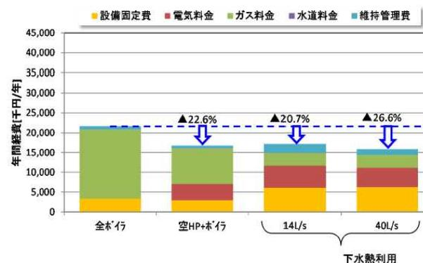
図 5-34 マンホール取水管路外流下液膜方式の年間経費の評価結果
