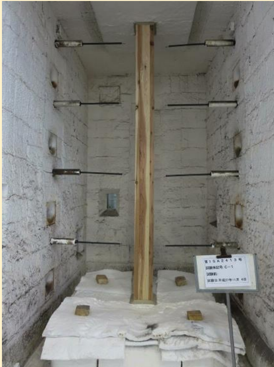
柱試験体 L 3.3m 試験体数: 3体 (集成材)
