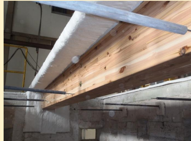
はり試験体 L 5.4m 試験体数: 3体 (集成材) 部材間の隙間 3mm
