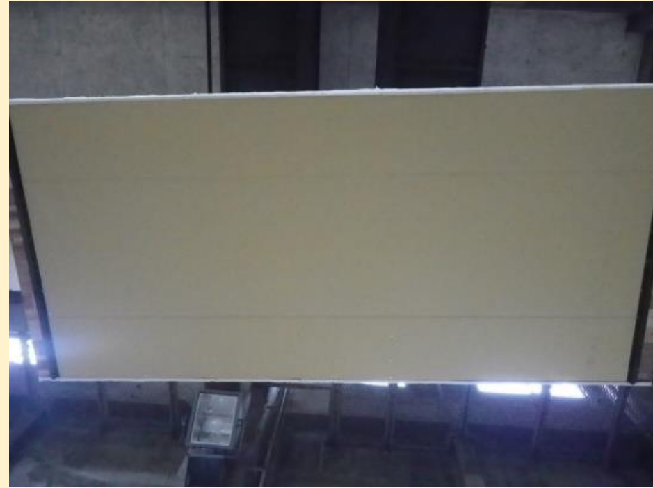
床試験体 L4.4m × D2.0m (支持スパン4.32m) 試験体数: 4体 (CLT、集成材)
