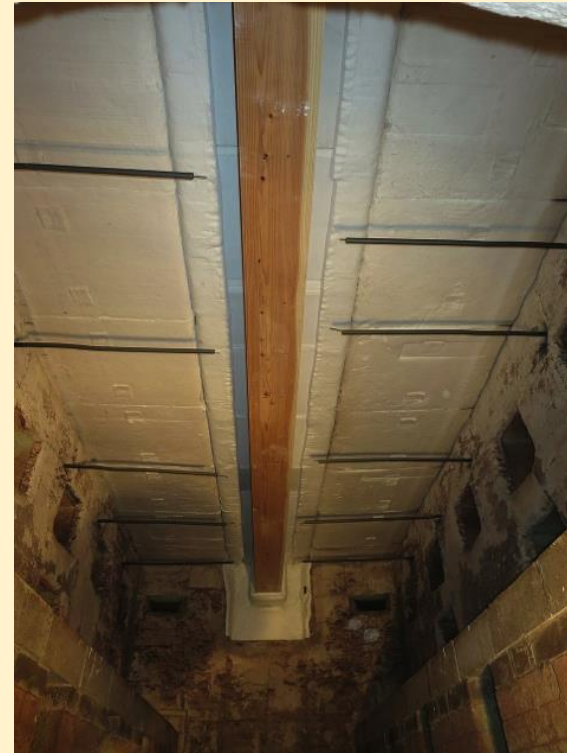
はり試験体 L 5.1m 試験体数: 2体 (集成材)
