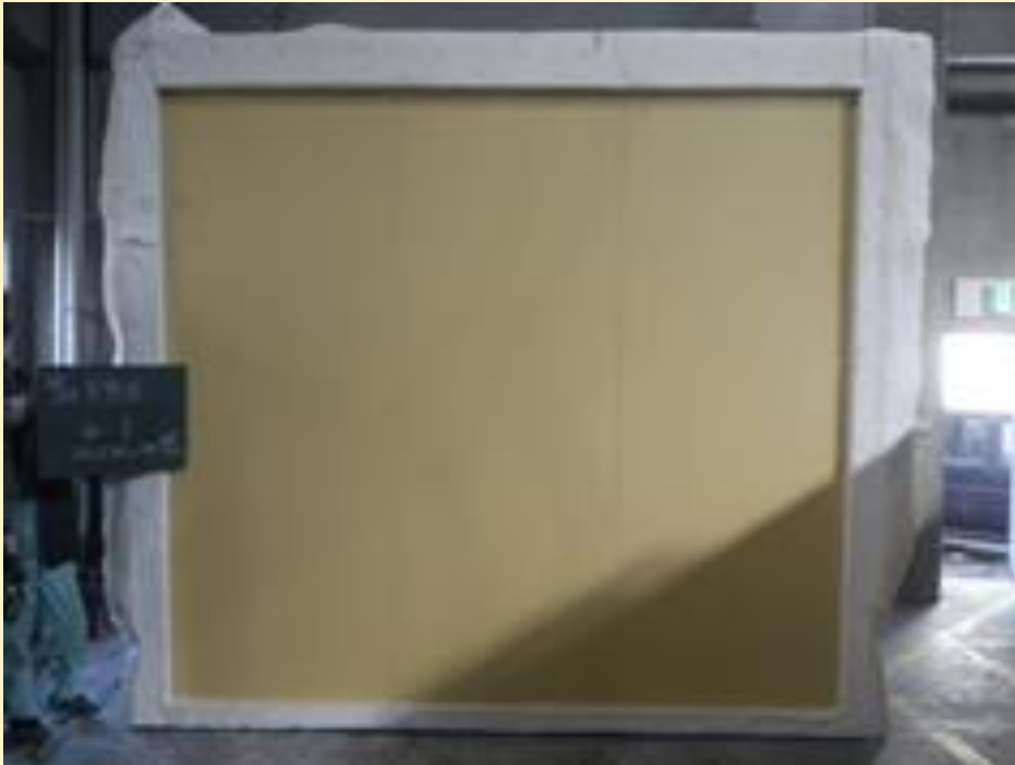
壁試験体 W3.2m × H3.0m (荷重支持部分W2.0m) 試験体数: 4体 (CLT、集成材)
