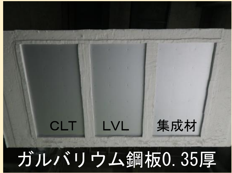
せっこうボード12.5厚被覆の260°C到達時間 (留め付け間隔200mm)
