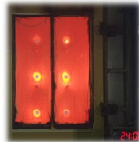
※網入りガラス+Low-Eガラスの複層ガラスと比較し、耐熱結晶化ガラス+Low-Eガラスの複層ガラスは、貫通又は非加熱側への着炎までの時間が同等もしくは上回っている。
