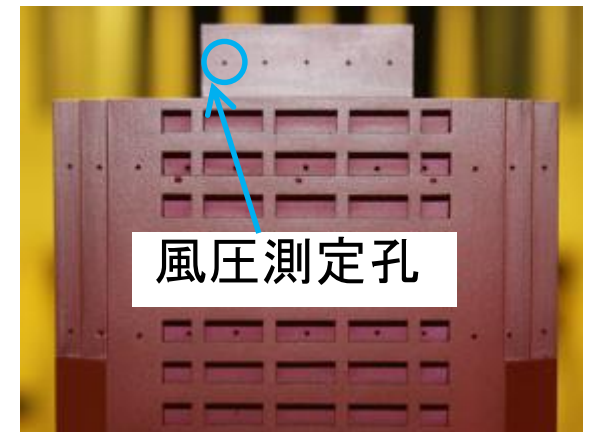
多点同時風圧計測(風圧模型)
