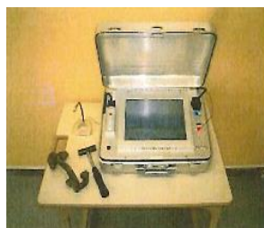
写真3.1 開発されたはく離検知器・装置の例
