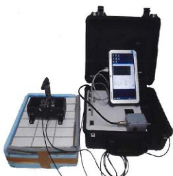
写真3.1 開発されたはく離検知器・装置の例
