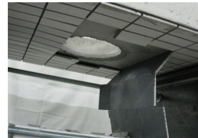
写真1.4 接着剤張りの試験後
