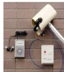
写真3.1 開発されたはく離検知器・装置の例
