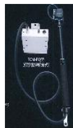
写真3.1 開発されたはく離検知器・装置の例
