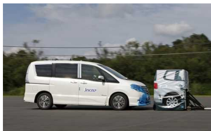
（衝突被害軽減ブレーキ試験の様子）
