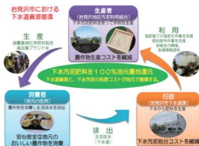
下水道資源循環型農業 (岩見沢地区汚泥利用組合)
