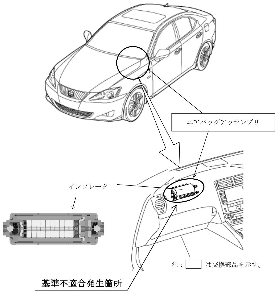
助手席用二段展開制御式エアバッグのインフレータ（膨張装置）において、ガス発生剤の吸湿防止が不適切なため、温度および湿度変化の繰り返しによりガス発生剤が劣化することがある。このため、エアバッグ展開時にインフレータ容器が破損するおそれがある。
