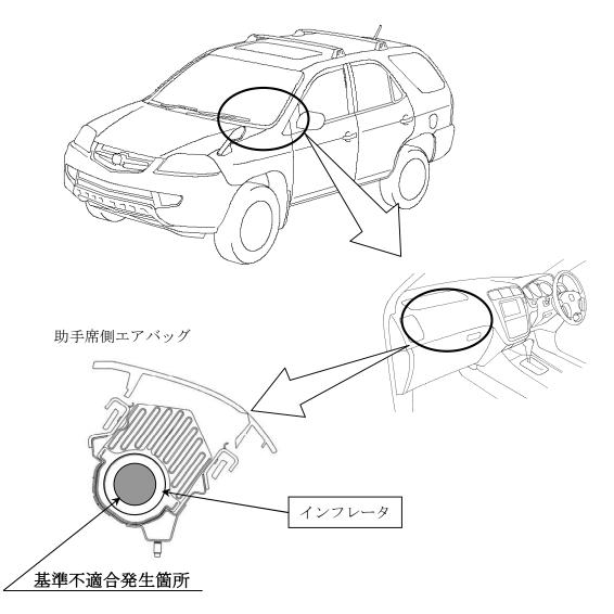
助手席側のエアバッグのインフレータ(膨張装置)において、環境温度および湿度変化の繰り返しによりガス発生剤が劣化することがある。そのため、エアバッグ展開時にインフレータ内圧が異常上昇して、インフレータ容器が破損するおそれがある。
