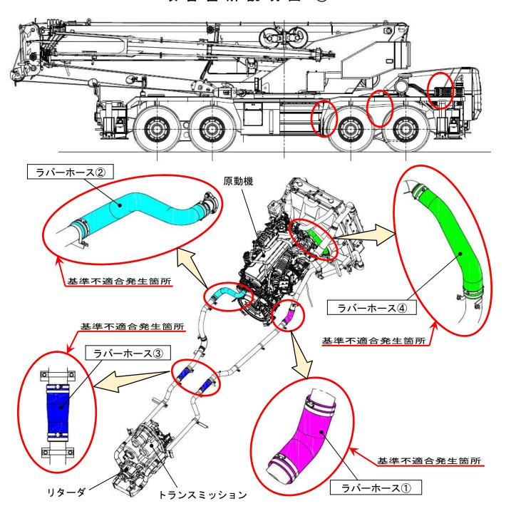
原動機冷却装置において、リターダ冷却装置のラバーホースの強度が不足しているため、当該ラバーホースが破損するものがある。そのため、そのまま使用を続けると、ラバーホースから冷却水が漏れて、 最悪の場合、エンジンが停止し走行不能になるおそれがある。
