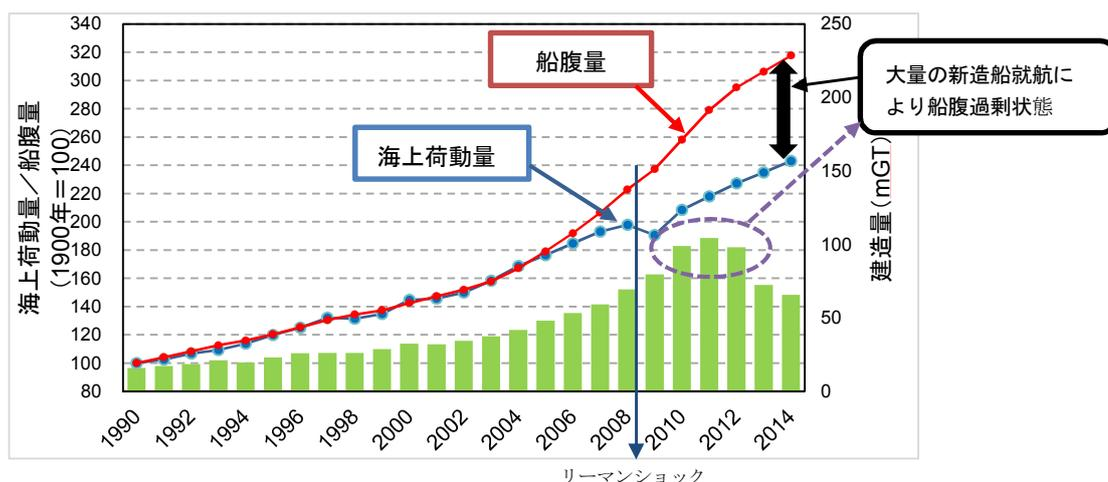
図3 海上荷動量、船腹量、建造量の推移
