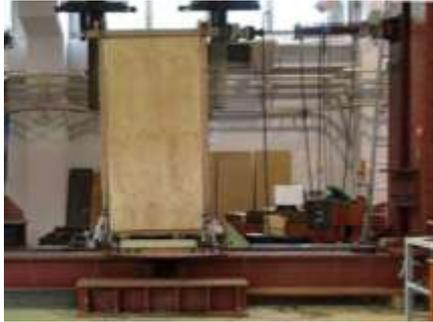
写真4 耐力壁の加力実験状況
