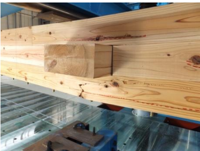
破壊時の荷重は1.4t。 中央载荷のため下端が破断している
