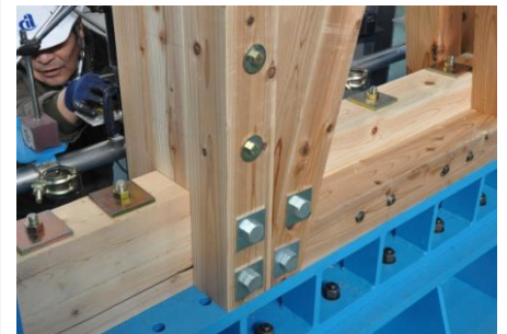
引っ張り側は5ミリ程度浮きが生じたが、圧縮側は密着している。部材への影響なかった。
