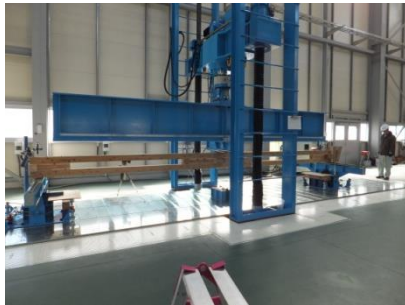
7mの2本の挟み柱の中央に荷重をかける
