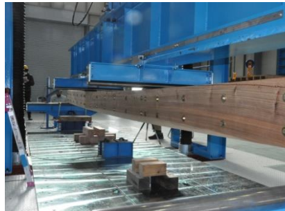
7m×1/25ミリで、2.0tの荷重。2点载荷により、均一にたわみが生じている。とつんの継ぎ手に異常はなかった
