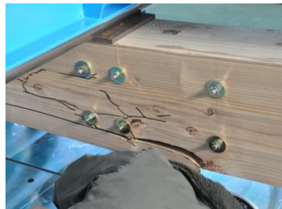
最終的に5.4tの負荷をかけた。たわみは120ミリとなり、破断させた。梁の下端は木目に沿って欠損した。
