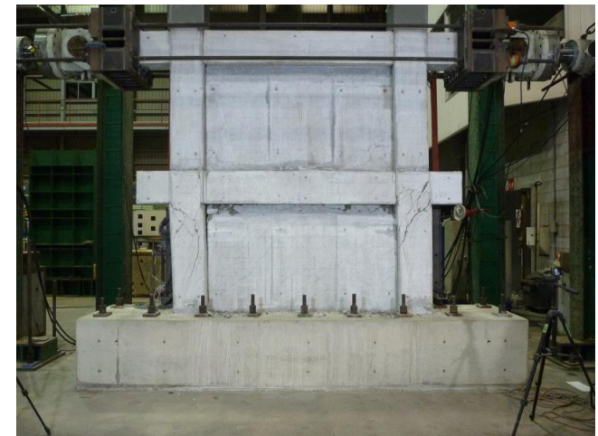
増設耐震壁実験
