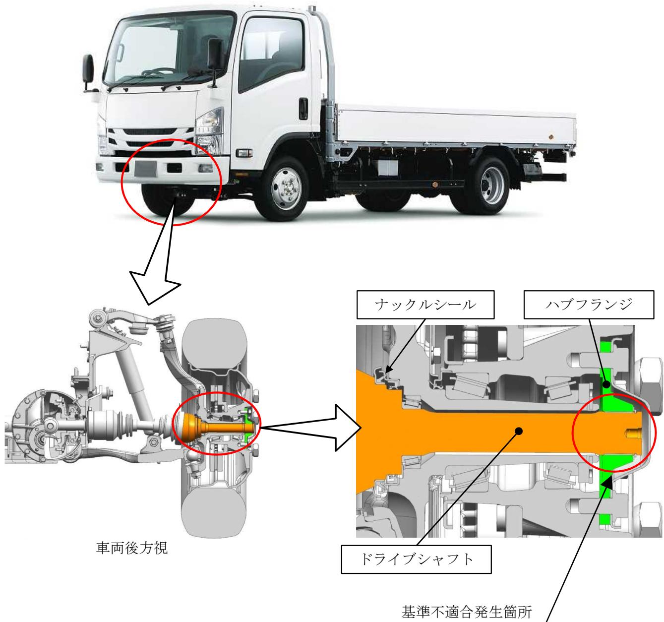
小型トラックのフルタイム式四輪駆動車のフロントハブフランジにおいて、ドライブシャフトを接合するスライン部の硬度が不足しているため、当該スライン部が摩耗することがある。そのため、異音が発生するとともに、そのままの状態で使用を続けると、ドライブシャフトが空転して、最悪の場合、走行不能となるおそれがある。
