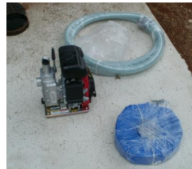
注水用ポンプ (エンジンポンプ・ホース等)
